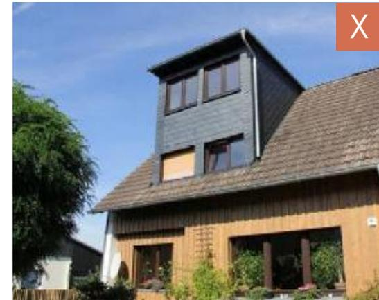
Abbildung 43: Überdimensionierte Dachgaube.
